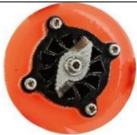
Изображение режущей системы насосов
