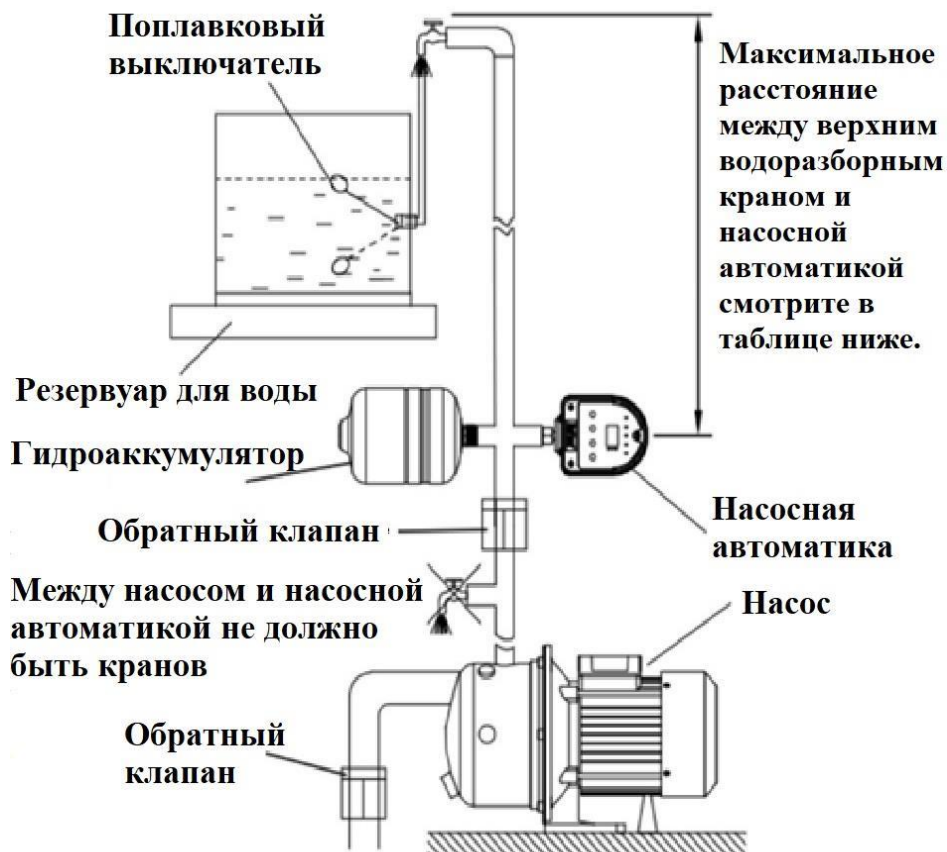
Максимальное расстояние между верхним водоразборным краном и насосной автоматикой модели РС-39.
